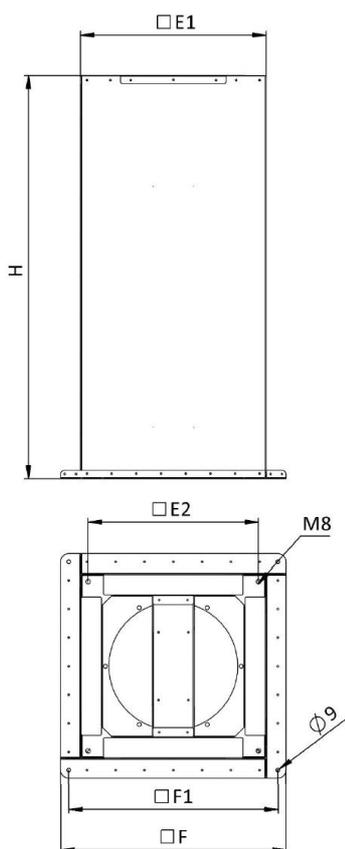
Монтажный стакан после установки должен быть тщательно герметизирован. При креплении вентилятора к монтажному стакану необходимо использовать шайбы с резиновой прокладкой.
