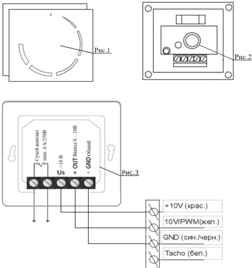
Пример подключения ЕС -двигателя!
