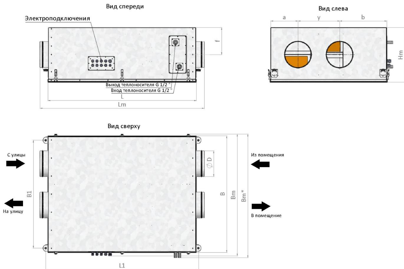
Размер Bm\* соответствует установке с водяным нагревателем.
