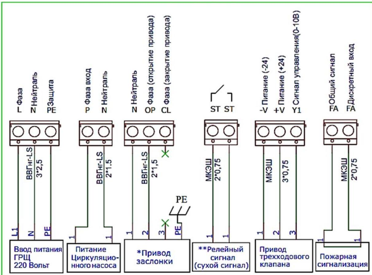
\*Пример подключения привода с возвратной пружиной. Для подключения приводов без возвратной пружины, предусмотрена клемма «CL».
