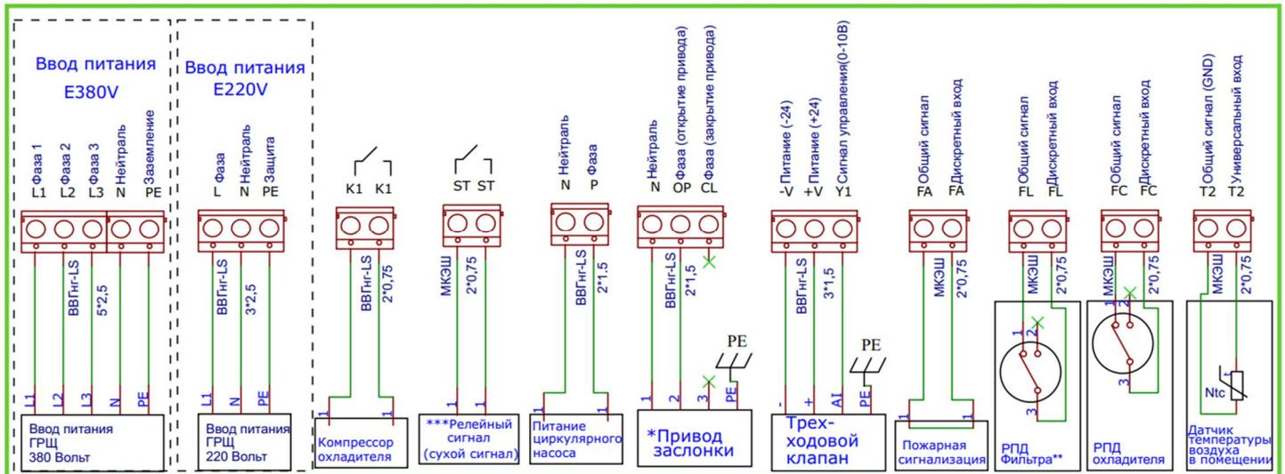
\*Пример подключения привода с возвратной пружиной. Для подключения приводов без возвратной пружины, предусмотрена клемма «CL».
